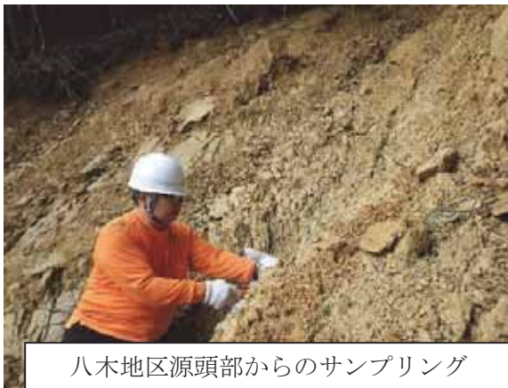
図2 八木・緑井地区の源頭部の崩壊とサンプリング写真
